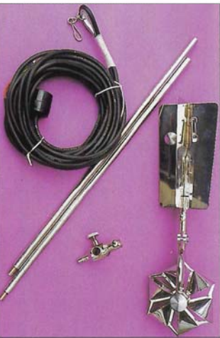
MOLINETE (MEDIDOR DE LA VELOCIDAD DEL AGUA) WATER CURRENT METER
