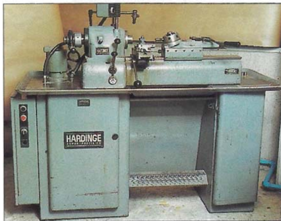
1 DE 3 TORNOS REVOLVER, MARCA HARDINGE, SUPER PRECISION, MODELO: DSM-59,
