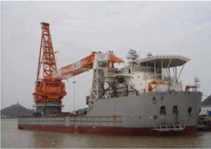
Barco Grúa utilizado para la instalación de Plataformas (Subestructuras y Superestructuras)
