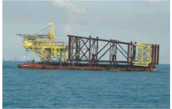
Tetrápodo (Subestructura y Superestructura)
