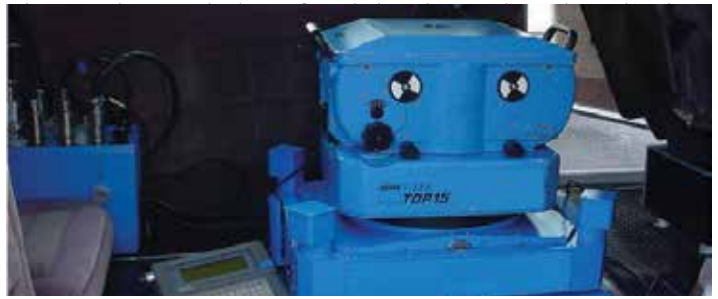
Fig. 1 Cámara métrica modelo RMKTOP NOTA. La cámara debe calibrarse cada año y contar con un certificado de calibración en dónde se especifican detalladamente los parámetros de calibración.
