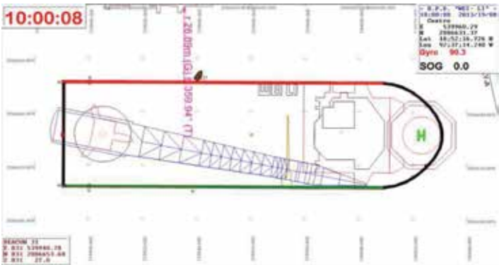
Representación gráfica del barco en el programa de navegación. Se levanta topográficamente para dibujarlo y visualizarlo mediante DGPS en tiempo real en la base de datos que es una carta náutica electrónica, en sistemas geodésico y UTM.
